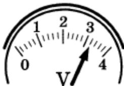
Запишите в ответ показания вольтметра в вольтах с учётом погрешности измерений.
