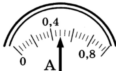
Запишите в ответ показания амперметра в амперах с учётом погрешности измерений.
